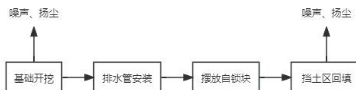
图 2-8 生态护岸工程施工工艺流程
